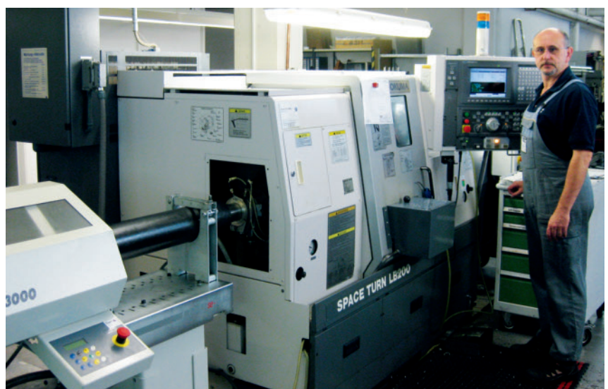
3 Das Verbindungsstück für Höchstdruckschläuche wird heute auf einer Okuma ›Space Turn LB200‹ prozesssicher von der Stange gefertigt
