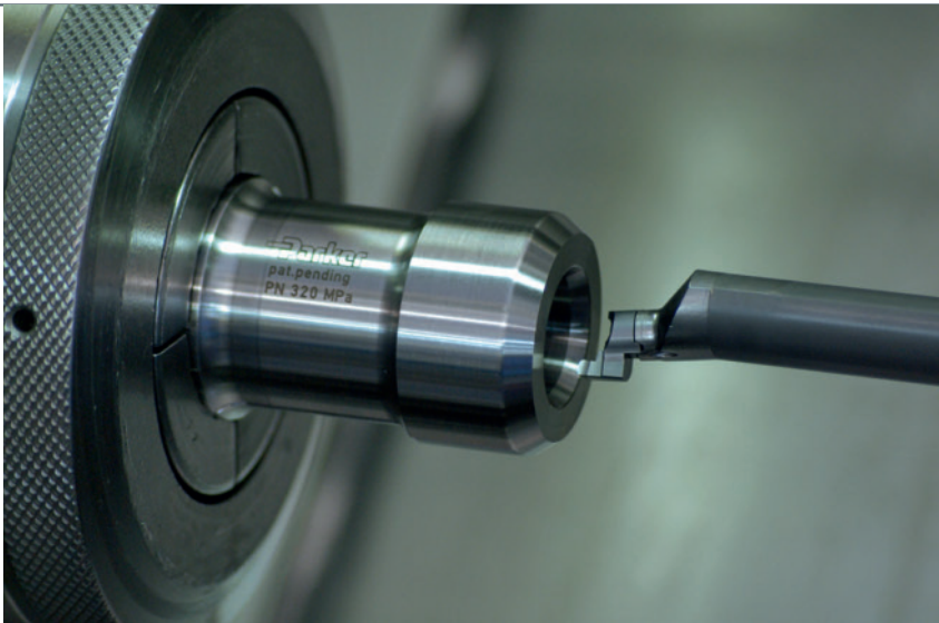
2 Für den Axialeinstich bei kleinem Spanraum wurden vom Werkzeugspezialisten Horn ein Sonderschaft und Sonderplatten gefertigt und der Schneidkopf versetzt
